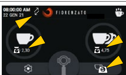
Màn hình HOME với "Hệ thống XGi" được kích hoạt (chế độ xay theo KHỐI LƯỢNG)
